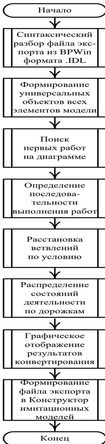
Рис. 1. Обобщенный алгоритм конвертирования
