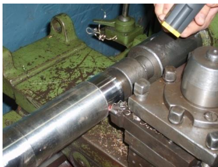
Рис. 2. Абразивный износ от частиц продукта обработки, при точении труднообрабатываемой стали 12Х18Н9Т резцом, оснащённым режущей керамикой марки ВОК-60
