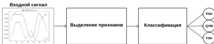
Рис. 1. Схема определения видов цифровой модуляции с использованием блока выделения признаков и классификатора
