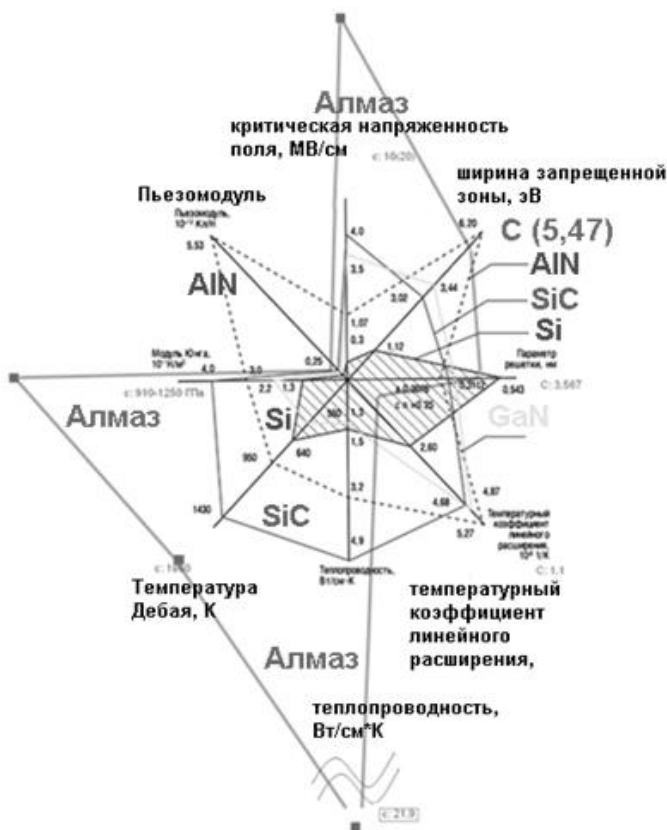
Рис. 1. Электрофизические параметры алмаза относительно других полупроводников
