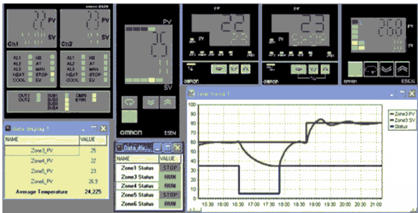
Рис. 1. Разделение экрана оператора на окна для мониторинга при производстве электронных компонентов
