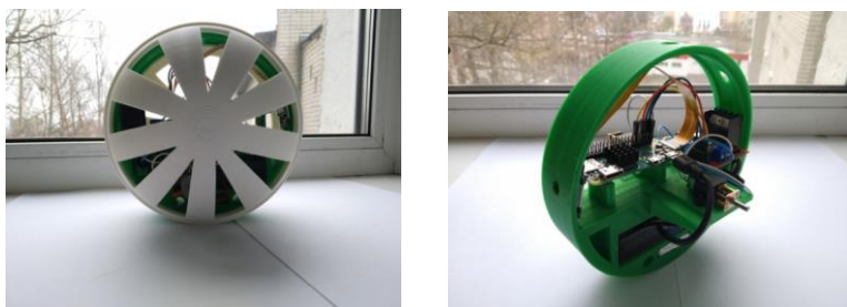
Рис. 2. Внешний и внутренний вид сферического робота V2
