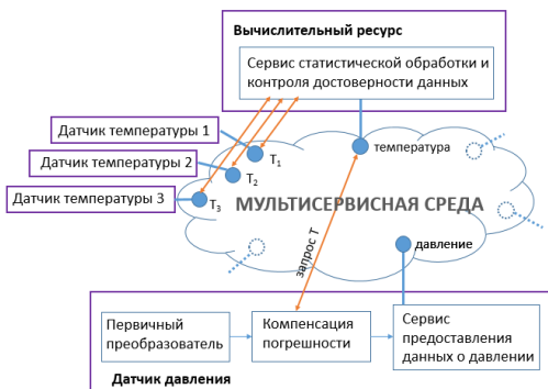
Рис. 2. Повышение надежности резервированием датчиков в мультисервисной среде
