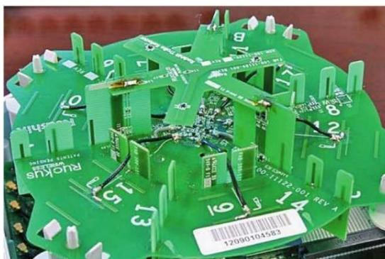
Рис. 1. Антенная система точки доступа
